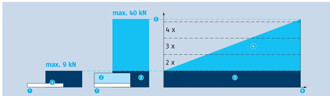
Bei der Turbo-Funktion reicht ein Luftimpuls, um die Einzugskraft der Federspannkraft um das bis zu 4fache zu steigern.
