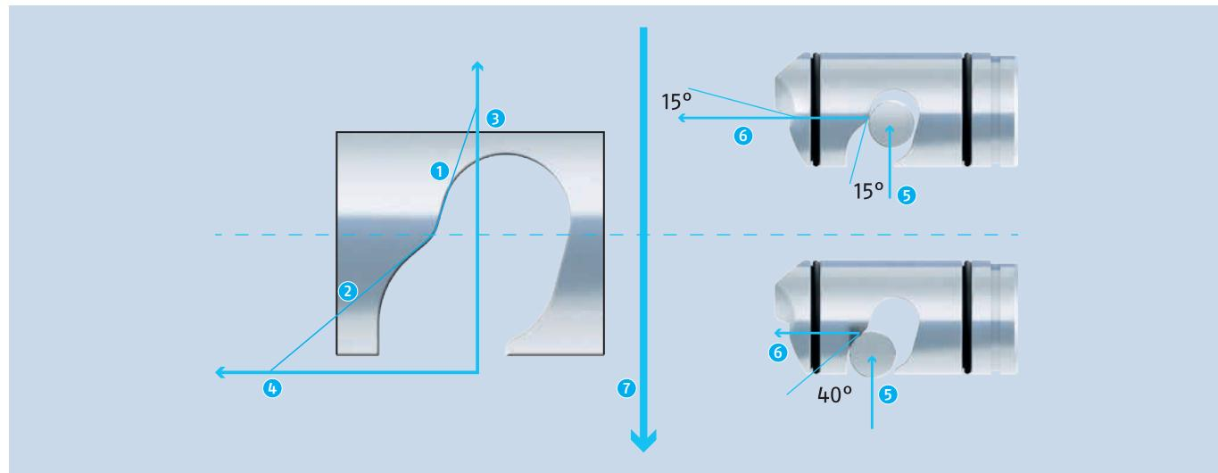
Der patentierte Eil- und Spannhub des VERO-S sorgt für beste Übersetzungsverhältnisse und damit für eine maximale Einzugskraft von bis zu 40 kN mit Turbo.
