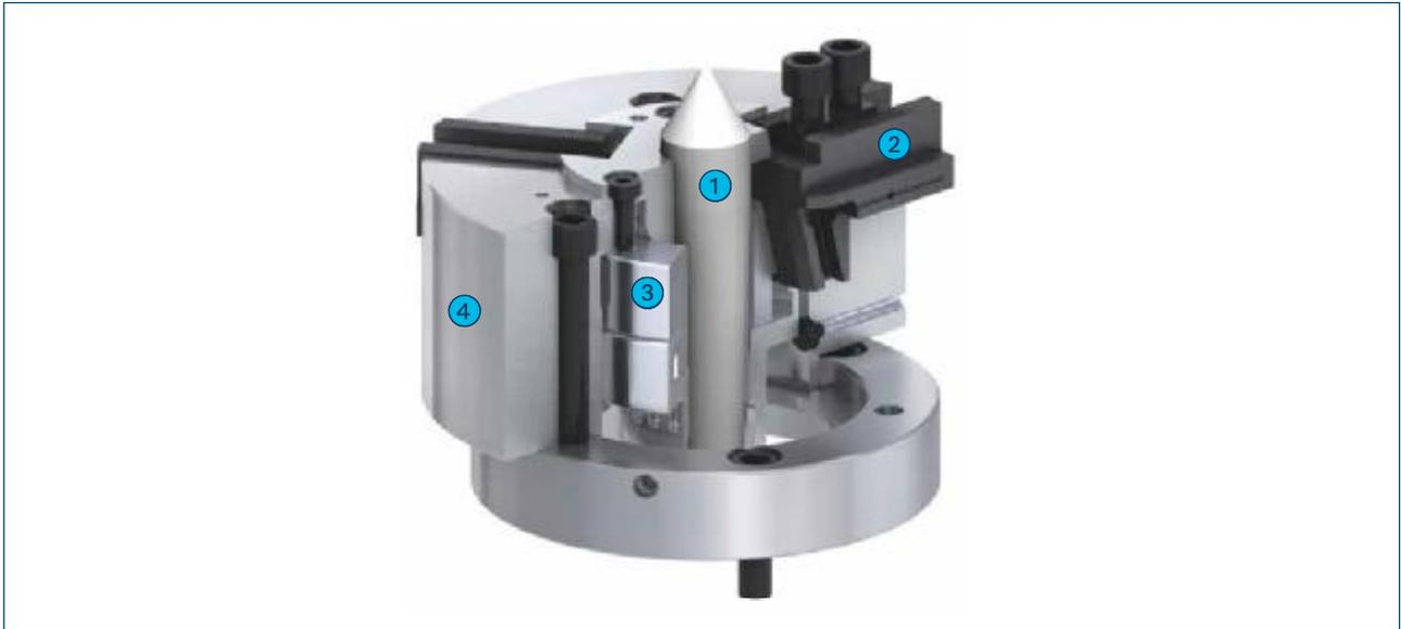
Das Werkstück wird in der Regel zwischen zwei Spitzen zentriert, die Backen legen sich ausgleichend an das Werkstück an und übertragen das Drehmoment. Der Ausgleich erfolgt über einen radial schwimmend gelagerten Spannkolben.
