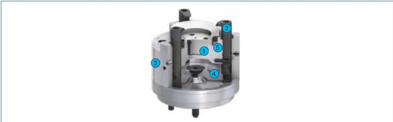
Das Drehfingerfutter zeichnet sich durch eine große axiale Spannkraft aus. Die Spannfinger erlauben eine einfache Beladung, auch bei automatisierten Vorgängen. Drehfingerfutter eignen sich besonders zum Spannen von Werkstücken, die sich nicht radial fassen lassen.
