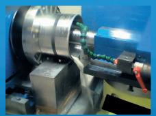
Vorteile: Energieneutrale Spannung, Keine Erwärmung der Platte sowie des Werkstücks, Hochpräzise Schleifarbeiten möglich.
