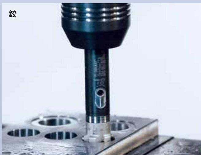
鉸孔加工中，液壓刀柄獨具的優秀的減震阻尼系統，確保工件表面的光潔度和工件尺寸的精度。
